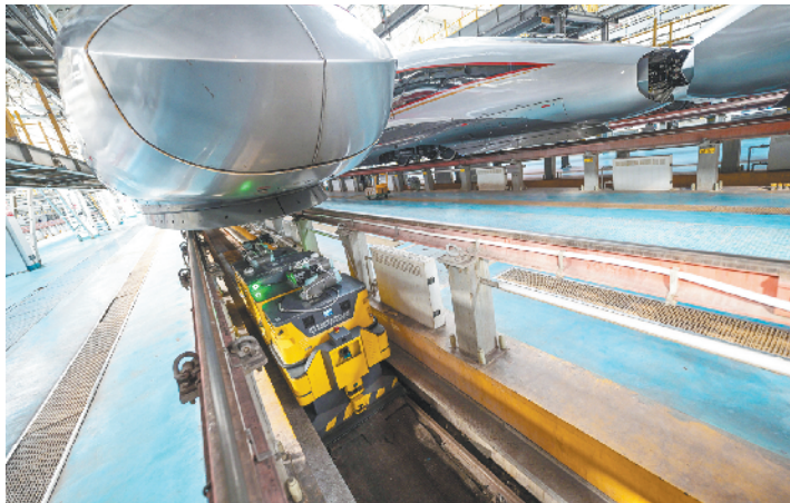
拥有两条金属手臂的智能检修机器人正在地沟内快速移动
