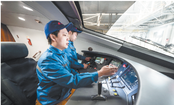
作业人员在驾驶室对车载设备以及列车通信系统进行测试
