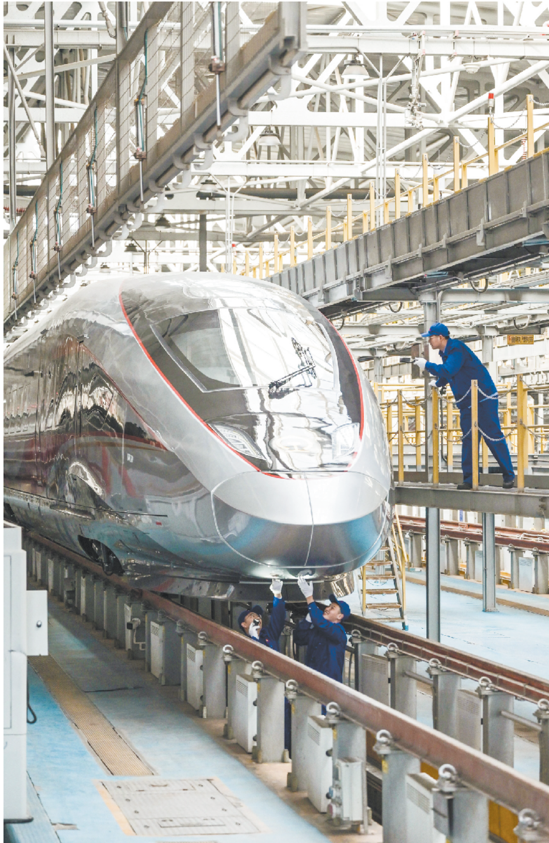
在“有电”作业中,地勤机械师要进行司机室试验作业,包括动车组制动试验车灯试验、全列车门开关试验等
