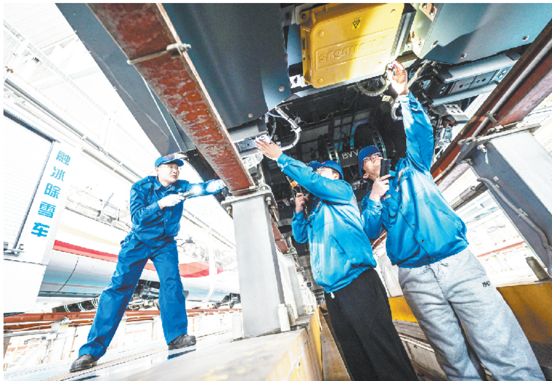
作业人员对动车组车底部件进行检查
