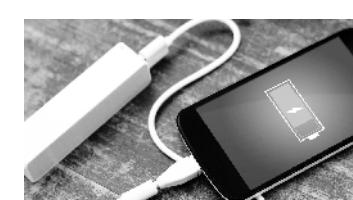
在充电过程中，手机和电池本身就会发热，如果夜间长时间充电，尤其是戴着厚重的手机壳，热量难以散发，电池相当于在做“桑拿”。而高温正是锂电池寿命的“隐形杀手”，长期如此会加速电池老化。
