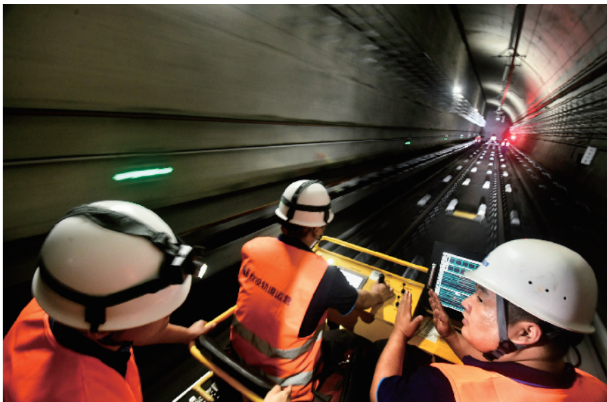
职工使用双轨探伤仪进行钢轨母材检测
