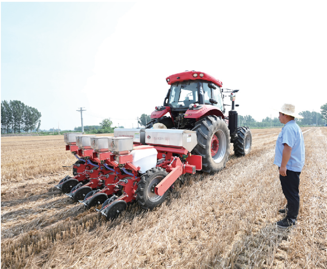
无人驾驶拖拉机装配了电控气吸播种机，实现种距、肥量精准调控
