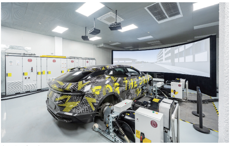
车辆系统在环实验
