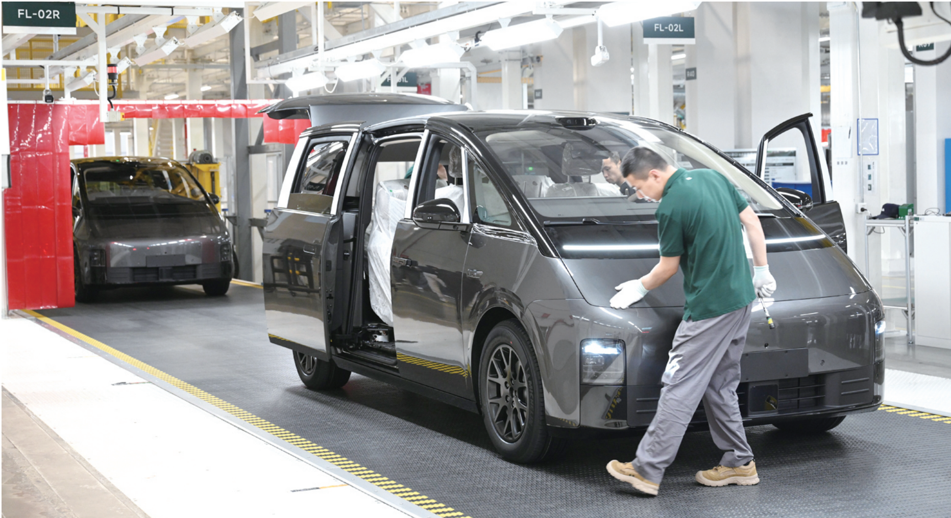
工作人员对生产完成的车辆进行初步检查
