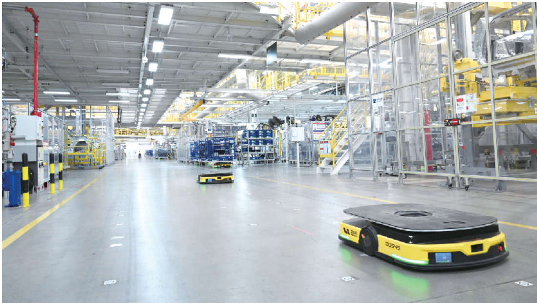
车间内AGV自动导引物流车高效地将各类零件配送到生产线上
