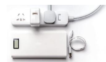
充电宝的电芯一般是锂离子电芯和锂聚合物电芯，要是把充电宝和钥匙、指甲刀这些金属小物件混放在一起，金属物品万一不小心插入充电宝的USB输出口，会导致电源短路。这种短路可能会引发火灾甚至爆炸。此外，钥匙等尖锐物品还容易刮伤接口，影响充电宝的正常使用。
