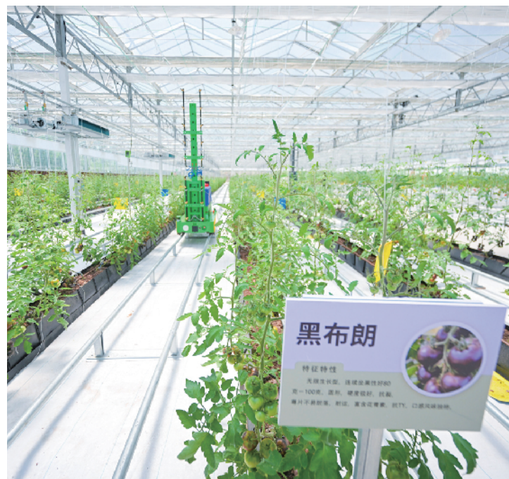
自动打药机器人喷洒生物菌剂抑制虫害
