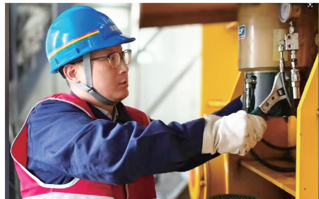
他不顾严寒，毅然钻进搅拌机仓检查，果然发现搅拌刀因高负荷运转折断。若不及时处理，极有可能引发严重生产事故。经过两个多小时的紧张抢修，设备终于恢复正常。
