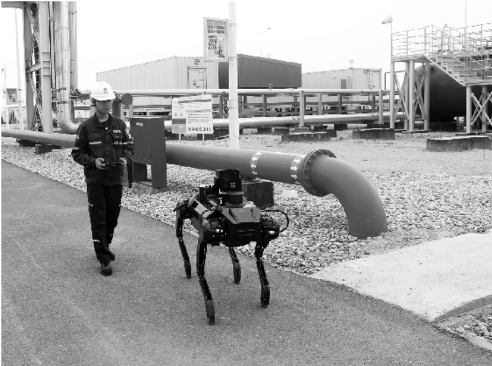
振华石油控股有限公司工程师调试防爆智能机器狗
