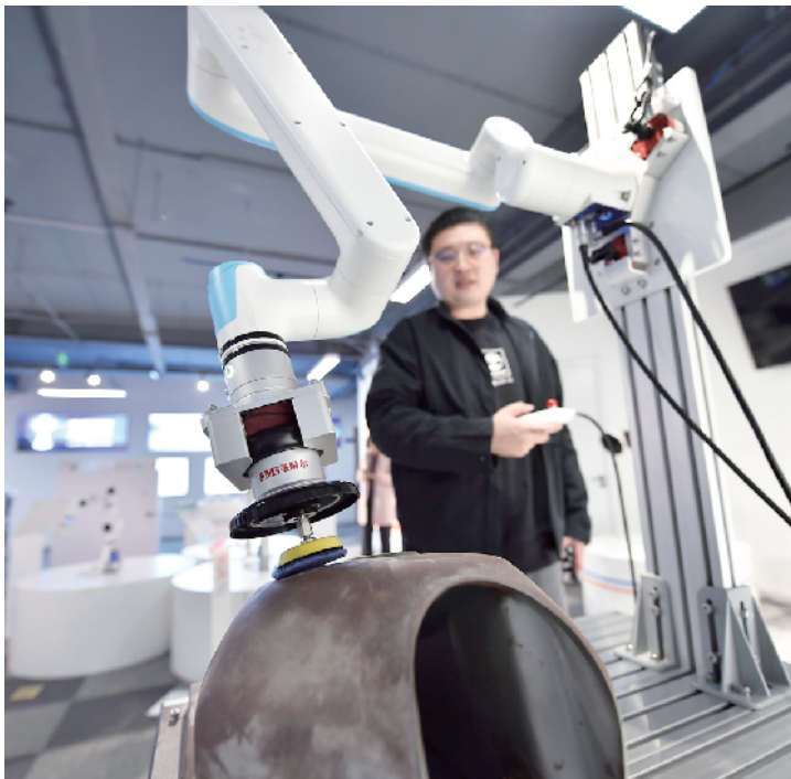
机械臂的末端可根据不同任务需求更换配件
