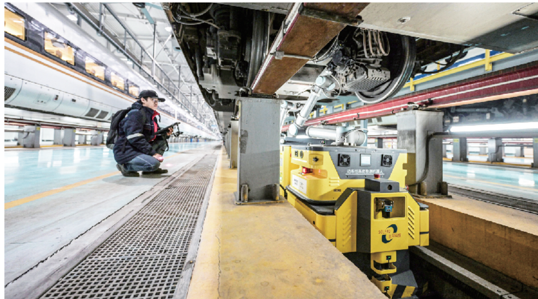
北京动车段北京北所工作人员操作动车组车底检测机器人
