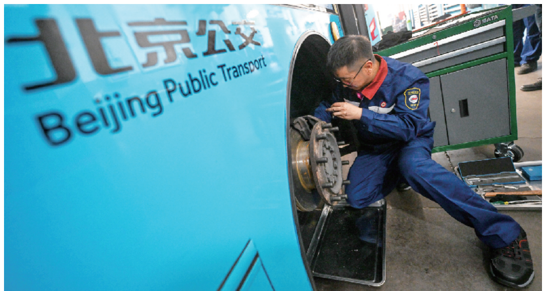
参赛选手正在进行盘式车轮制动器深度检查及测量
