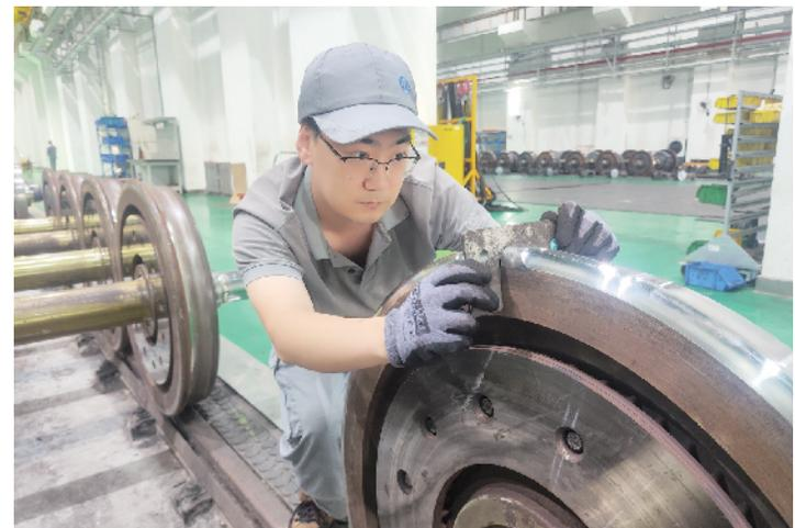
“镟轮是一项对技术要求非常高的工作，精准度要精确到毫米，差一点也不行。”张腾达介绍，一轮下来通常要耗时40多分钟，碰到难缠的故障轮对，维修时间还要加倍。
