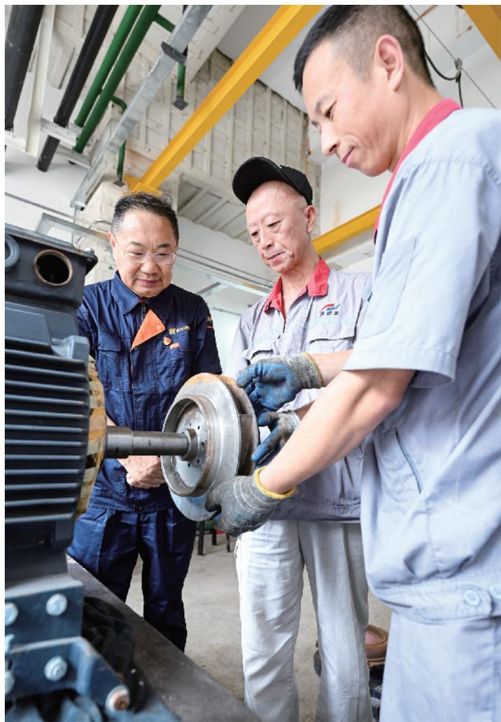
技术人员熟练安装清洗好的水泵零件
