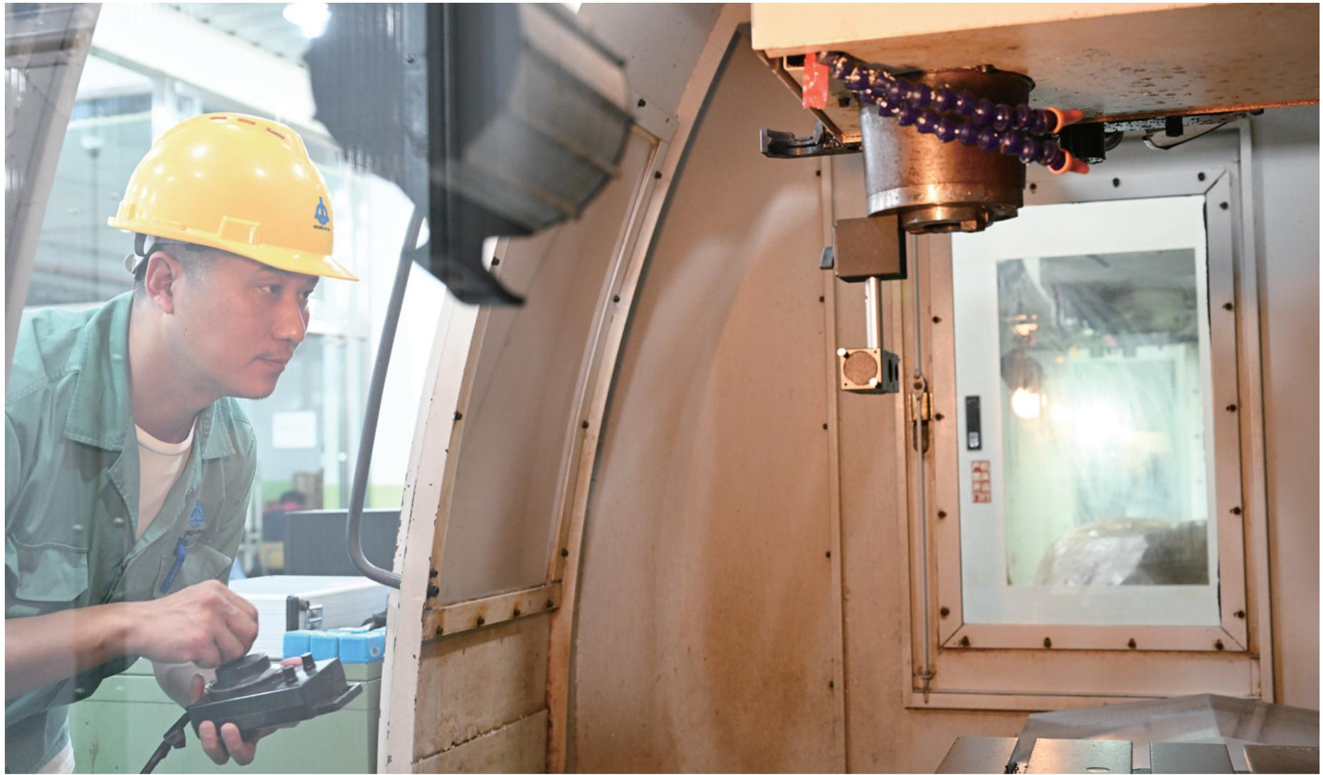
在机床定位精度测量与补偿的考试项目中，选手正在对激光干涉仪进行操作
