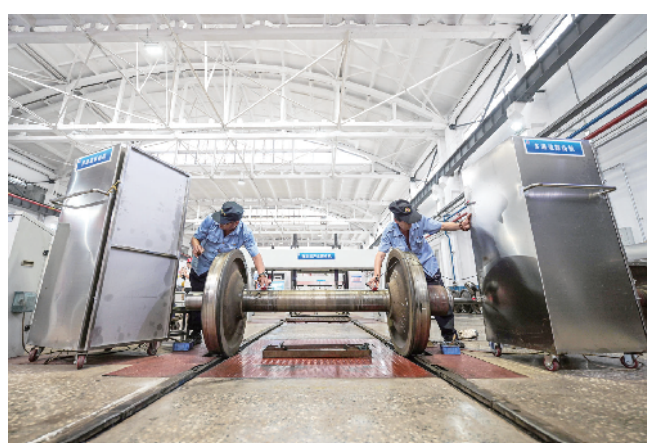
使用探伤机对车轮进行检测
