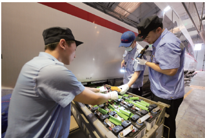
检查动车蓄电池
