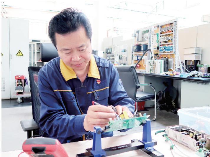
贵。该模块包括8块集成电路板，每块电路板上都有100多个电子元件和上千种逻辑关系，一旦出现故障，后续更换维保较为复杂。高增旺决定对该模块进行拆解，
