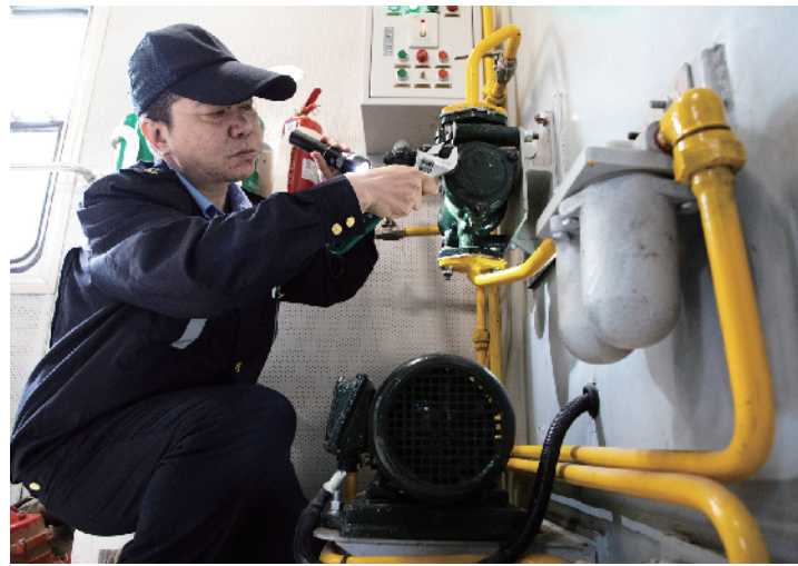
工作人员重点对列车走行部、发电车机组、空调机组进行检修
