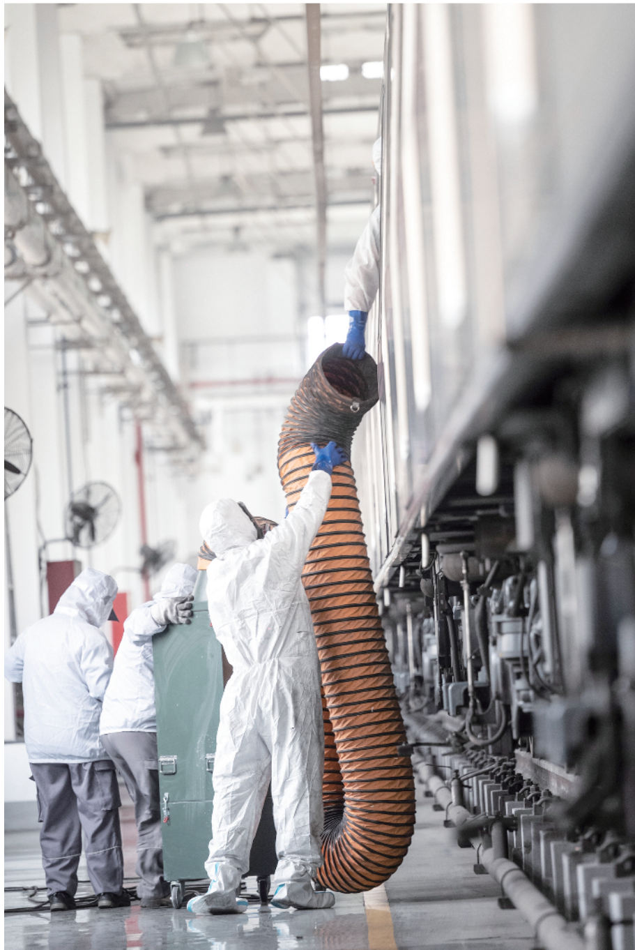
清理人员头戴防尘面具、身着白色防护服、手持鼓风机和负压吸尘器步步推进
