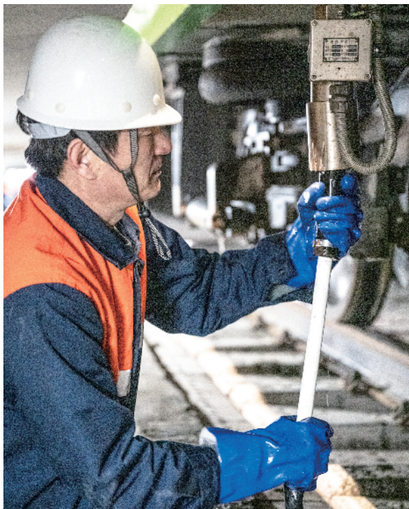
北京丰台站普速车场是中空站台，采用抬臂仰头插管上水的方法提高工作效率
