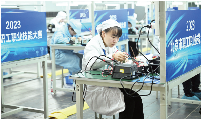
实操考试内容包括电子元件焊装与解焊、线束绑扎和功能调试
