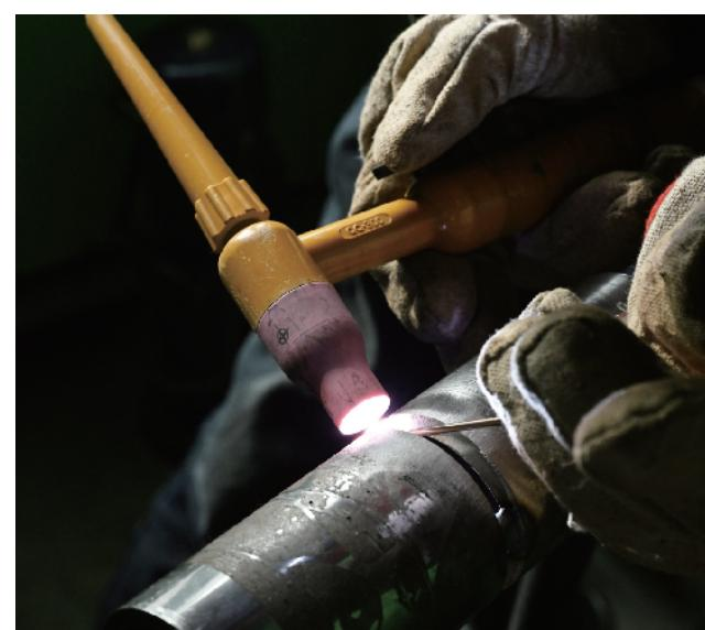
在比赛中，选手左手持焊丝，右手持焊枪进行焊接
