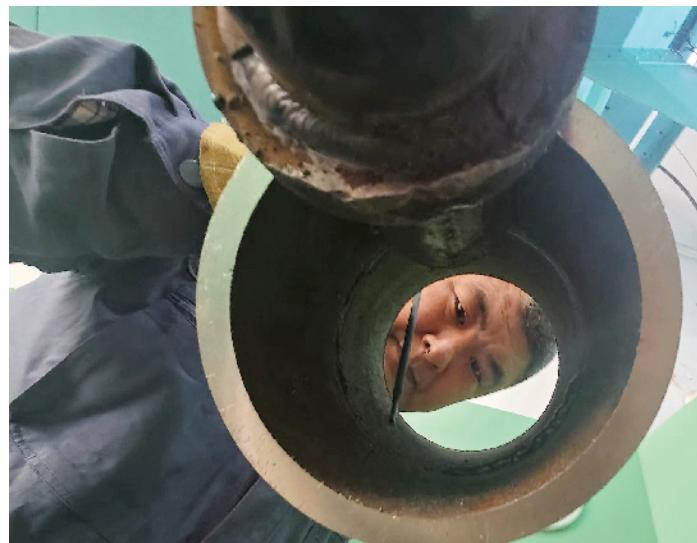
选手精心剔除飞溅，力求焊缝干净利落
