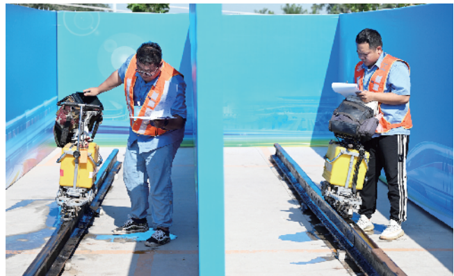
选手们细心地推行钢轨超声波探伤仪检查母材
