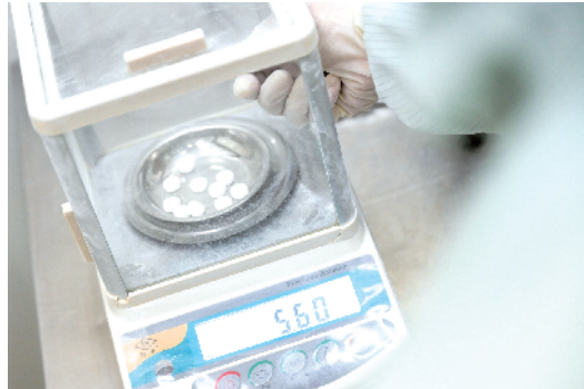
新生产的药片准备接受硬度、脆碎度等质量检验
