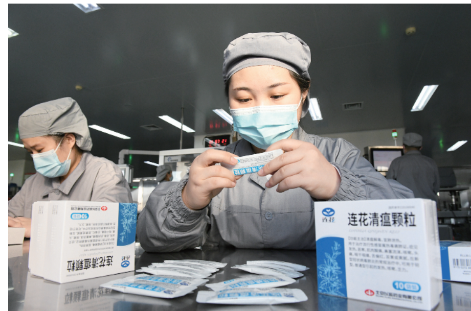
药厂职工正在对莲花清瘟颗粒的批号、重量、说明书等进行仔细核对
