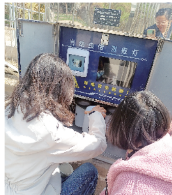
技术人员正在检测智能型太阳能虫情测报灯
