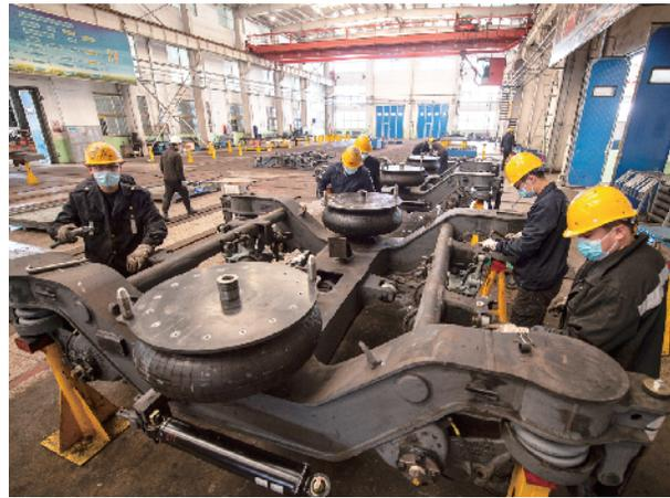
“毛泽东号”式班组正在组装客车转向架
