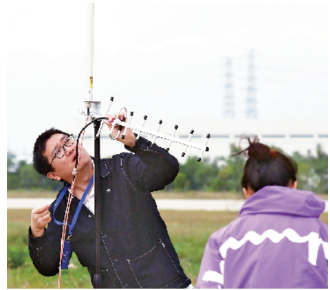
工作人员在架设无人机遥控天线
