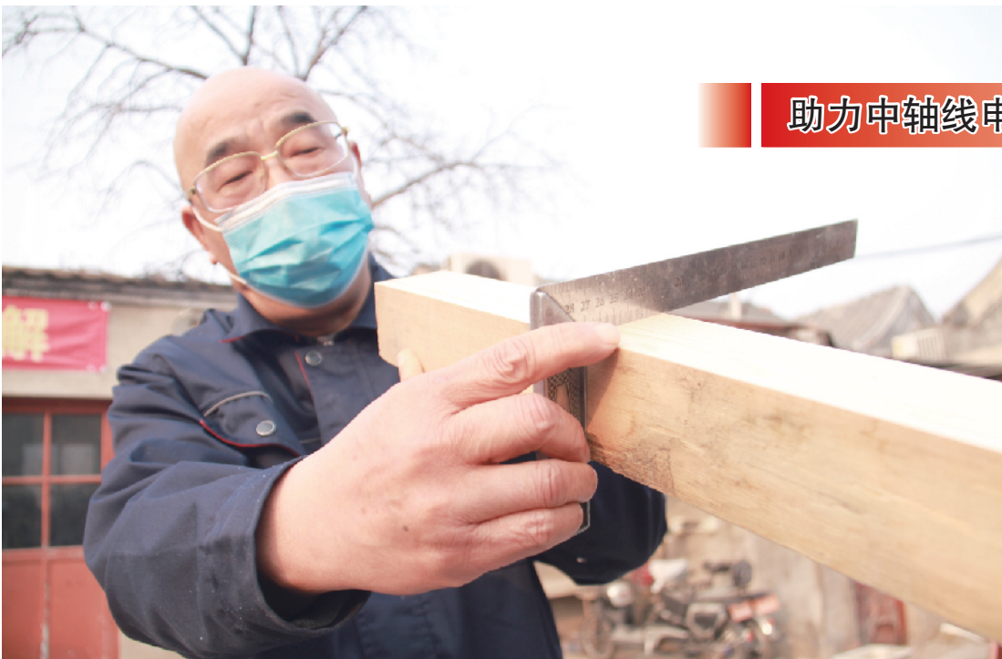
用直角尺测量刨子找平后的木料
