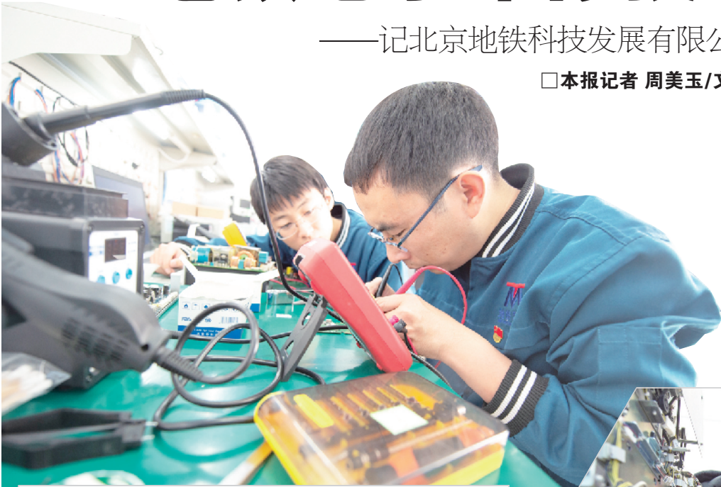
◀ 用仪表测量每一个器件，排查故障。
