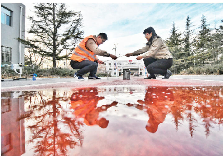
柳浩与试验员进行沥青路面抗滑性能试验
