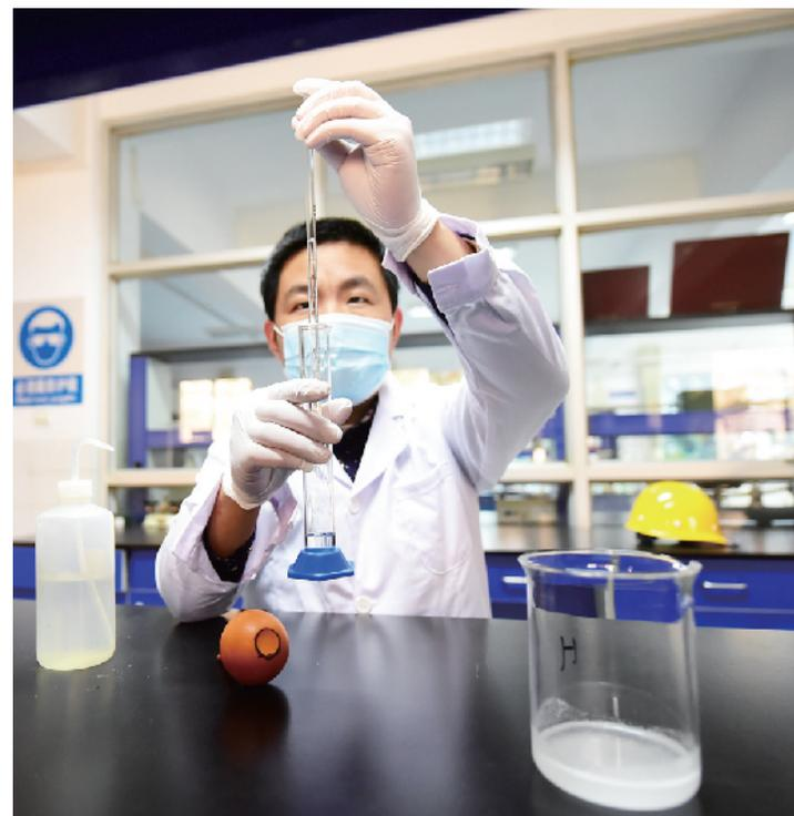
滴定实验，对固废样品进行检测。
