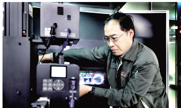
孙灿在做车辆仪表背光色度对比试验。
