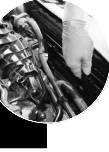
冷凝器下部会沾染上泥沙或其他脏物，这些物质时间久了就会使冷凝器发生锈蚀，影响空调的使用寿命。
