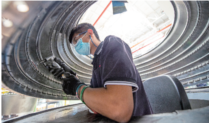
发动机车间内，技师对发动机部件进行打磨。
