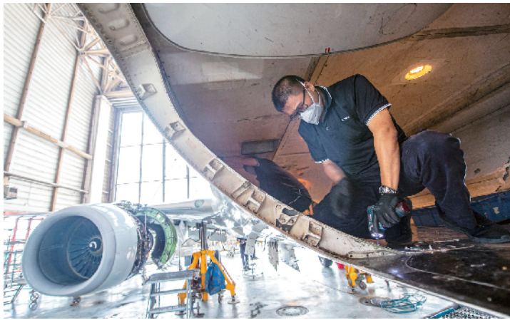
技师拆除飞机货舱的地板，查看内部是否有腐蚀等情况发生。
