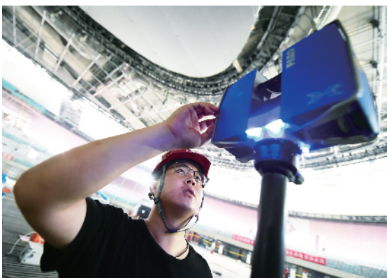
施工人员用站式三维激光扫描仪测绘全景图。
