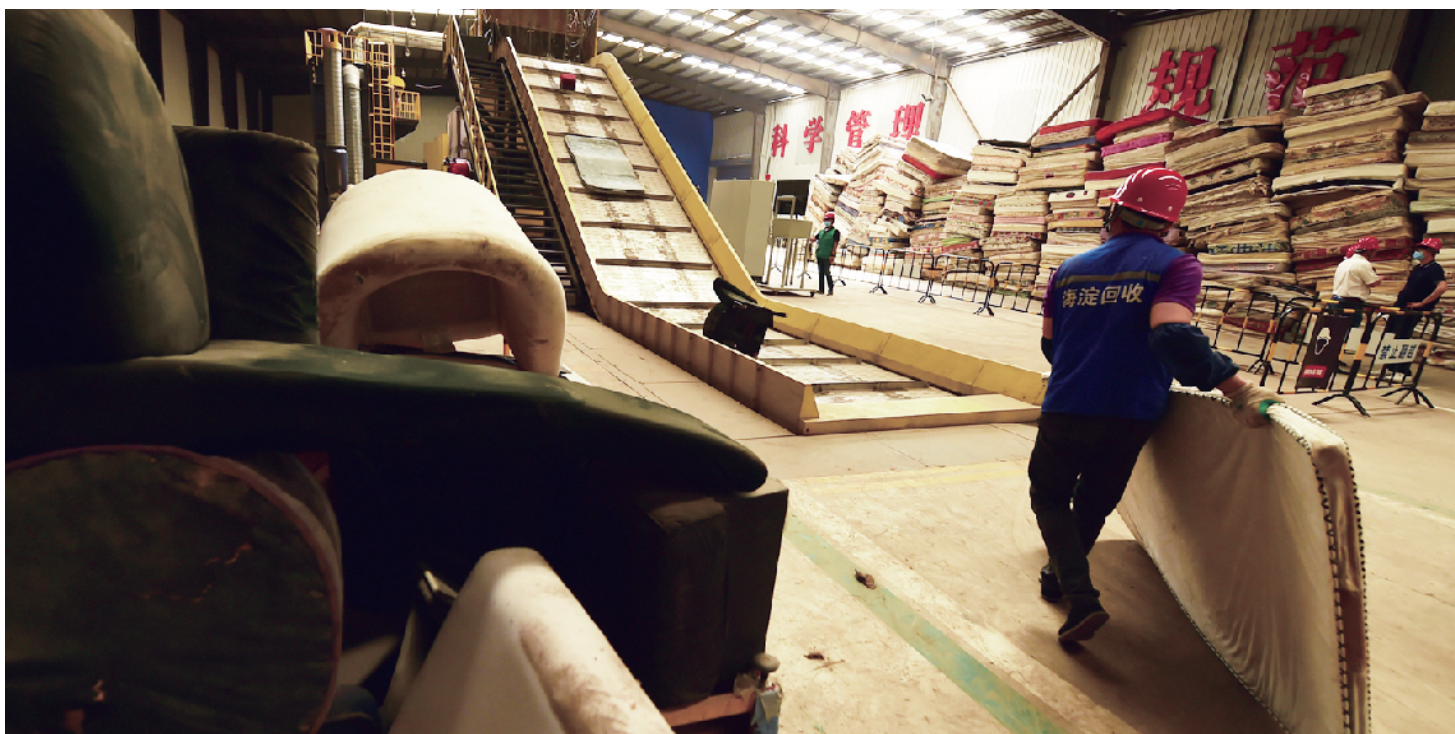
工人对废旧桌椅、床垫等大件垃圾进行破碎，然后分类处理。
