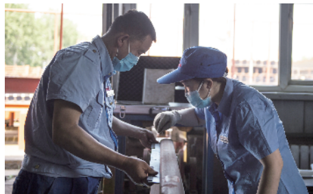
焊接工利用检测尺对钢轨进行检查。
