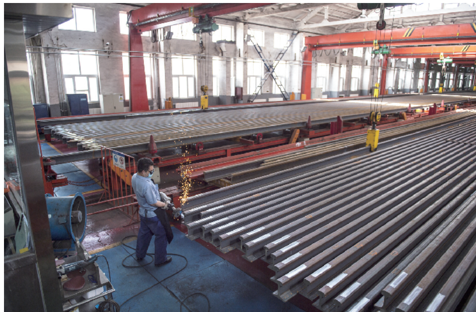
车间内，工人正在对钢轨焊接处进行除锈处理。
