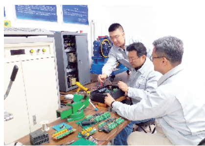
2018年，陶建伟与工作室研发人员进行无机房电梯自动救援操作装置科研项目系统调试。
