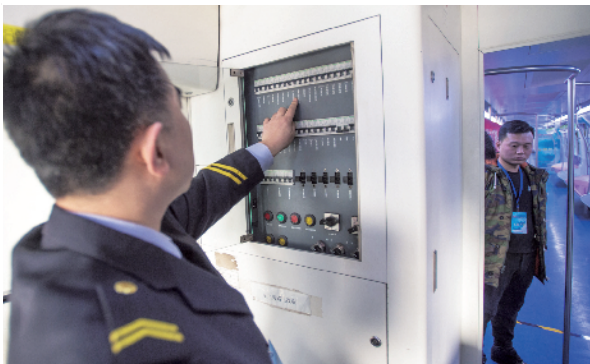
▲选手对车辆的电路控制系统进行检查，找出事故原因。
