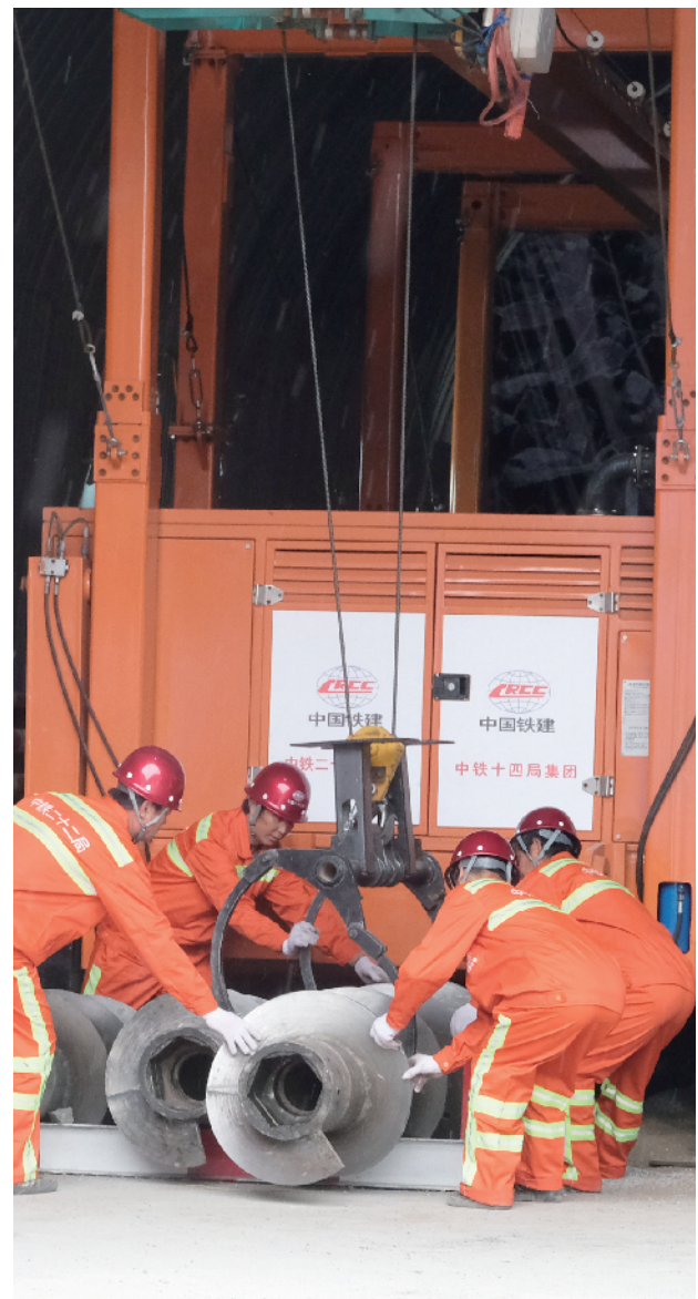
塌方隧道采用隧道双套管救援钻机等高科技应急监测和管理设备，快速营救“被困人员”。
