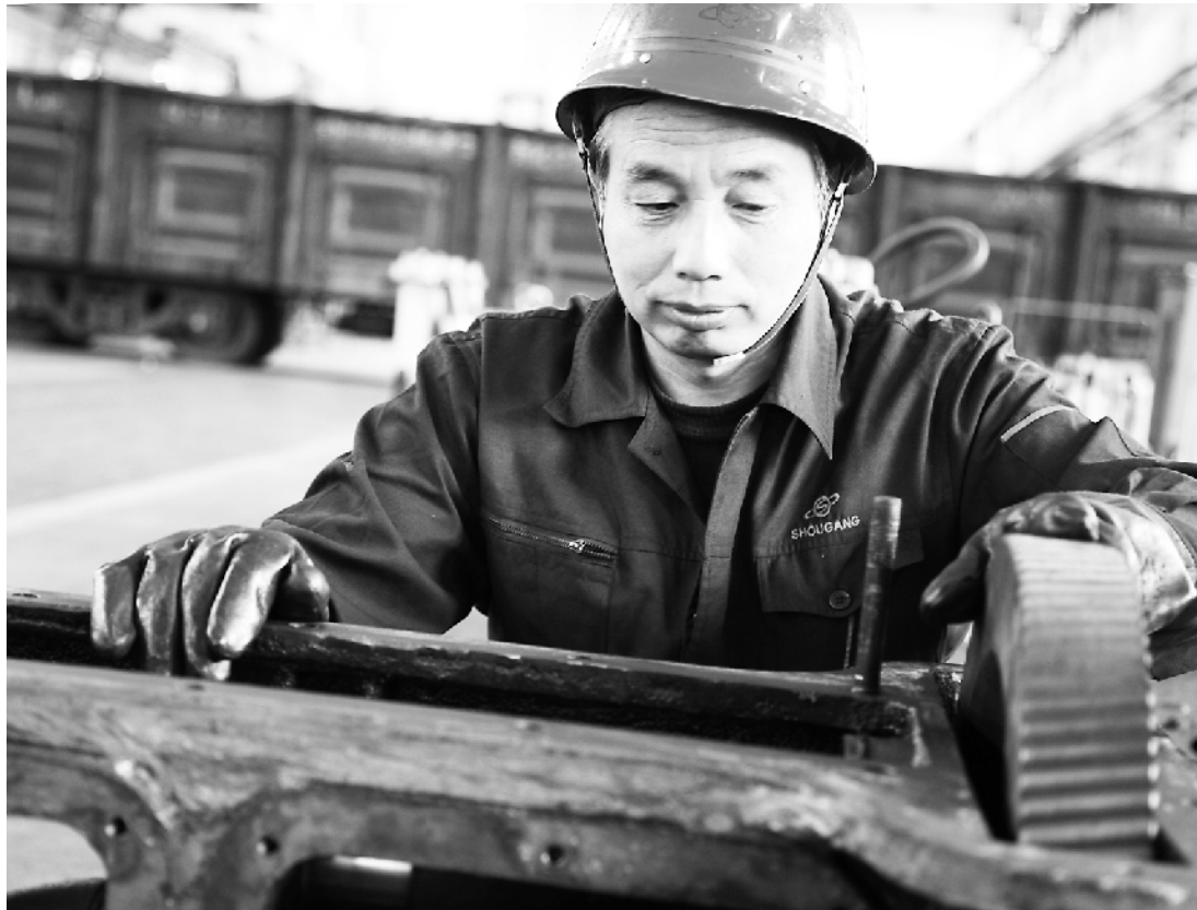
易广生检查内燃机车传动箱一轴轴承油隙和齿面的磨损度
