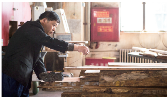
整根木材切割，刘更生用最传统的墨线标出切割线。
