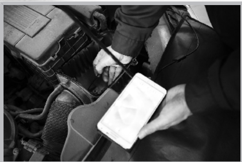
魏俊强通过内窥镜检查车辆内部故障。
