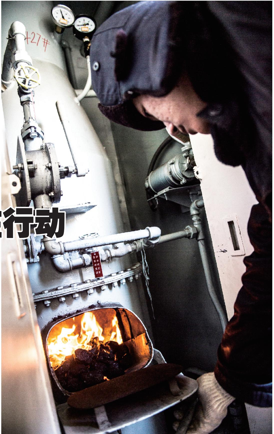
检修人员对车辆的供暖系统进行测试。
