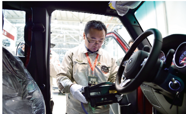
电脑检测排除故障
