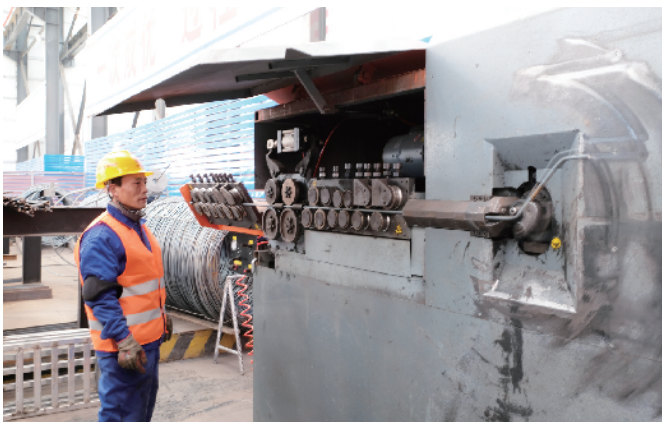
用电脑控制,可以对各类钢材的下料、剪切、弯曲等多项工序进行加工,提升了钢筋产品的精度,减少损耗,有效避免了人工操作的误差
