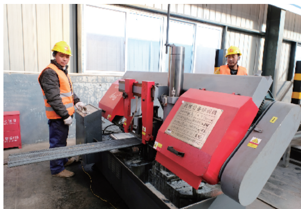
工人用数控切割钢筋合格率达到100%
