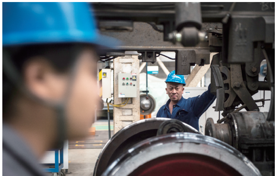
▲四名工人要将构架准确的放到轮轴上。
