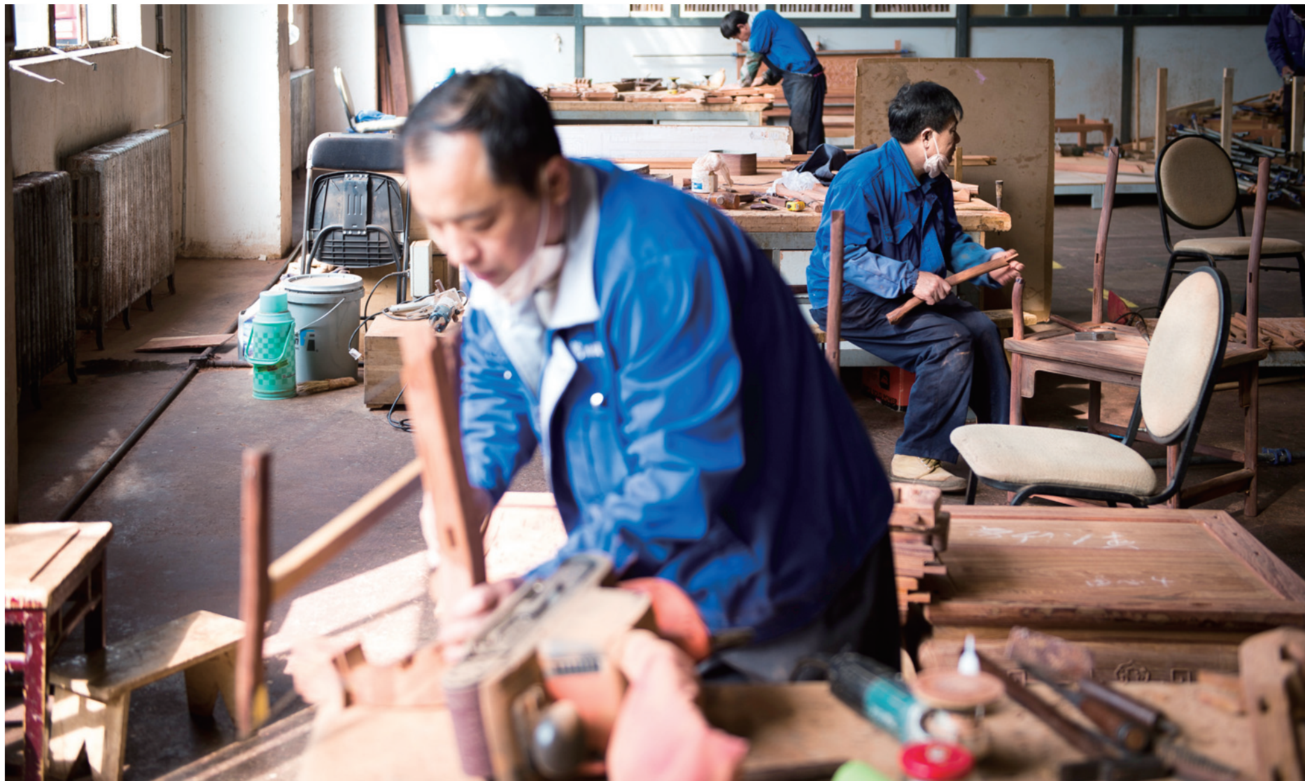
家具总装区，一名工人正在安装椅子扶手。
