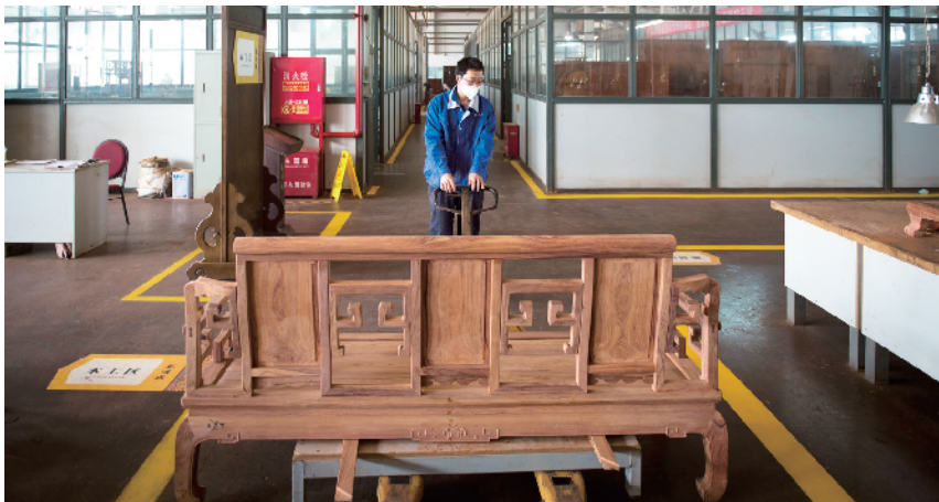
工人将安装好的家具，送往打磨区进行打磨、烫蜡等工序。
