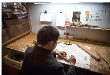
在榫卯定位区，刘更生会根据家具设计图纸，用尺子精确丈量，利用台钻，也就是人们常说的打孔机进行打孔。
